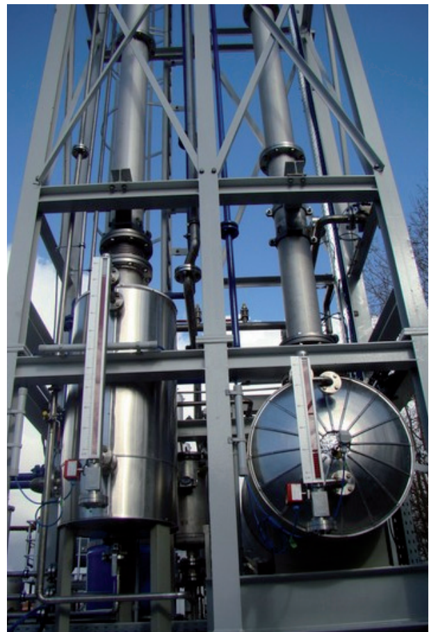
Bild 2 Technikumsanlage (links: Absorptionskolonne, rechts: Regenerationskolonne)
